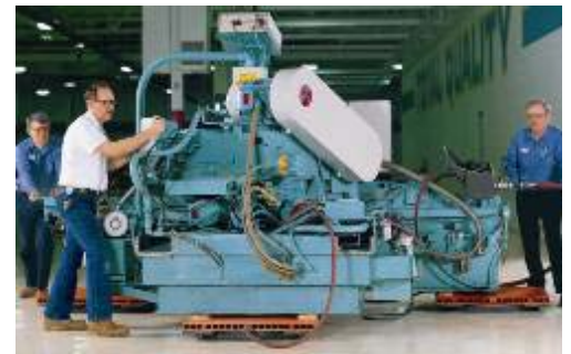
El sistema de distribución del inyector de aire hace que mover máquinas como la unidad que se muestra arriba sea más fácil.
